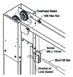
Fig. 9a - Overhead Limit Switch Power Side
